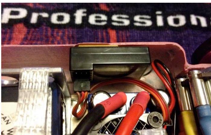
Mottagaren från Futaba, är en STD. 3 kanals 2,4Mhz.
